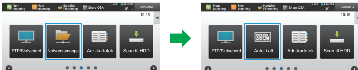
Ændring af en genvejstast fra "Netværksmappe" til "Antal i alt" i startsidens indstillinger.
